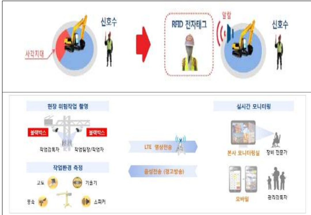
그림 1_장비접근시스템 개념도(상)과 타워크레인 혼합형 블랙박스 개념도(하)
